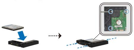
**b** Установите держатель дисков 2,5 дюйма в отсек для дисков и продвиньте вперед, пока диск не подключится к разъему SATA. Зафиксируйте держатель с помощью винтов, входящих в комплект поставки.
